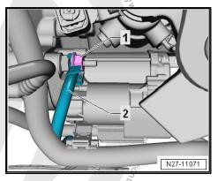
If equipped remove the ground cable -2-.
