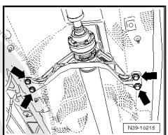
When removing and installing the driveshaft, be careful not to damage the bushing -arrow-. Sugar purpor spania politica de la particio del particio del particio de la particio del la particio de la particio del la particio de la par
